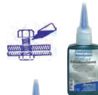
80508 Ökoprofi 2K70 50 ml Sicher hochvibrations- und schlagbeanspruchte Schrauben, Muttern, Stehbolzen gegen das Losdrehen und dichtet gleichzeitig ab. Für dauerhafte Schraubverbindungen, die sich nicht mehr lösen dürfen, \*Mit normalem Werkzeug schwer demontierbar (erwärmen auf 300°C)
